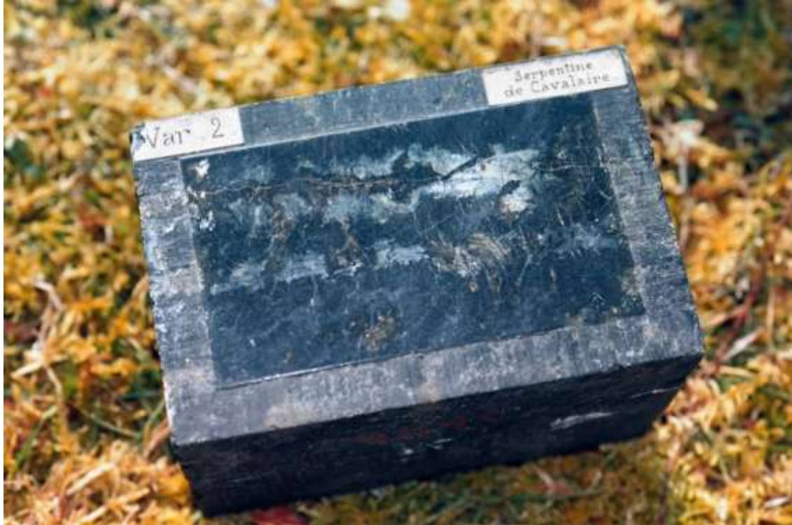
Serpentine de Cavalaire : spécimen de référence 10x5x5 cm pour les Monuments Historiques. Collection lithothèque du BRGM, Orléans (photo FERAUD).
